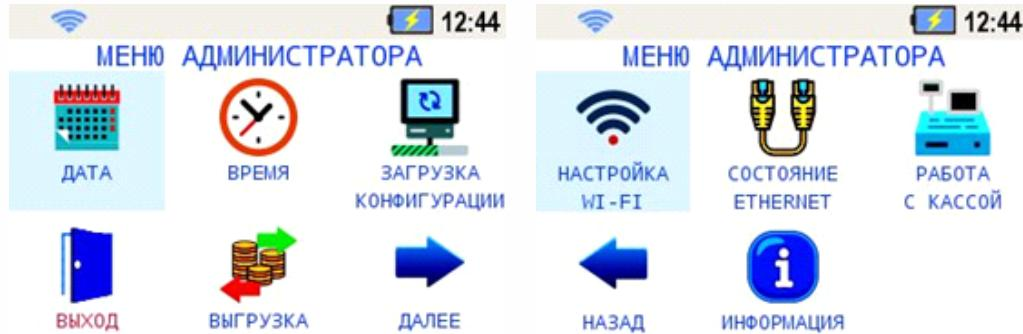
Администратор имеет возможности настройки даты\времени, получения конфигурации, настройки и просмотра состояний Wi-Fi и Ethernet, теста связи с банком, также возможность просмотра регистрационного номера оборудования.
