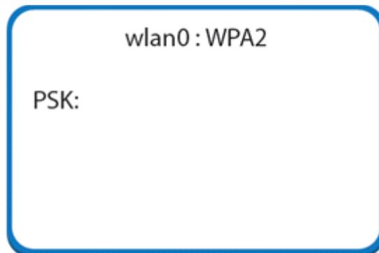
Для обновления списка беспроводных сетей нажмите желтую клавишу «CLEAR». Выберите из списка нужную сеть и нажмите зеленую клавишу. Устройство предложит ввести пароль для подключения к сети. Введите корректный пароль и нажмите зеленую клавишу. Произойдет подключение к выбранной беспроводной сети.
